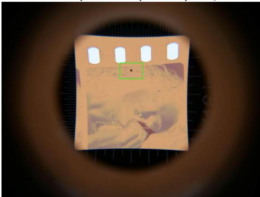
FIGURA 3 - Resquício de metal próximo às perfurações.
