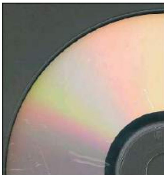
Figura 38 – Ranhuras na base de policarbonato 32
