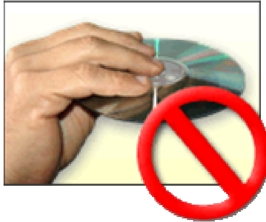
Figura 32 – Não tocar a superfície do disco
