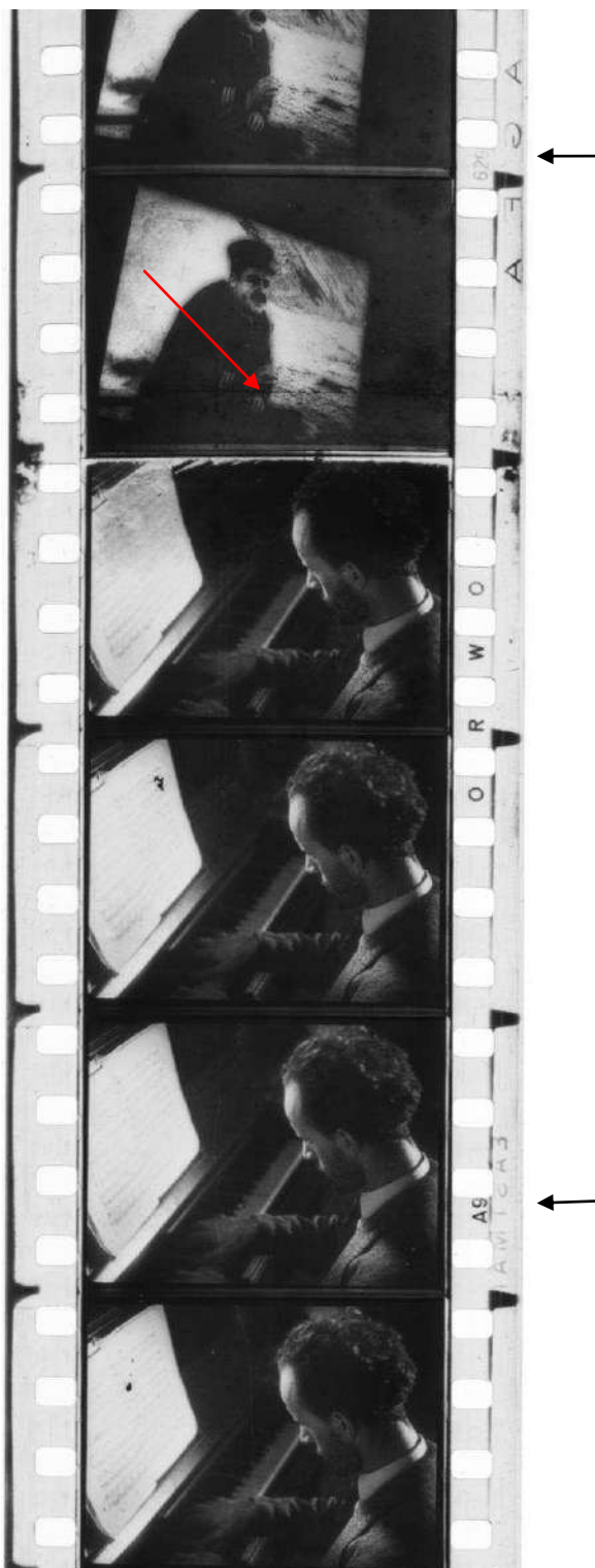
Imagem 36 - Marca de emenda com contornos escuros e mudança de base no Máster MAM.
