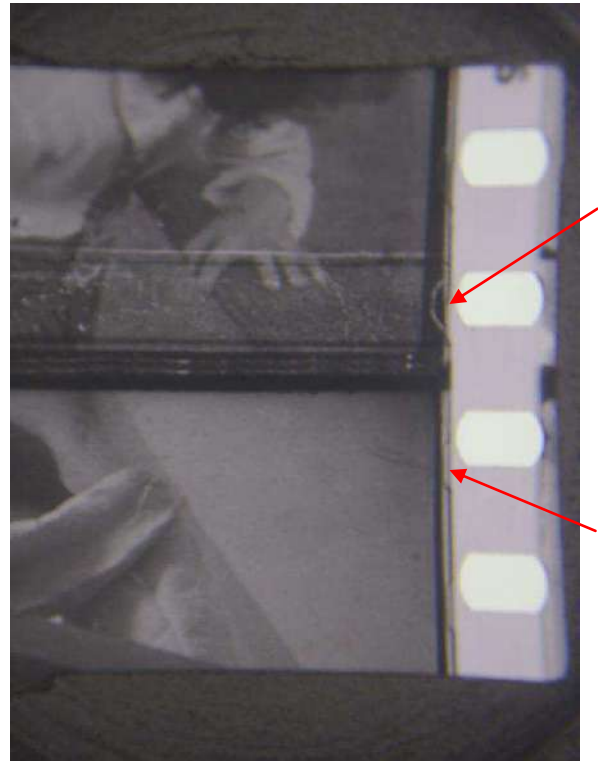
Imagem 11 - Marcas de perfurações de materiais positivos e negativos anteriores ao Máster CB.
