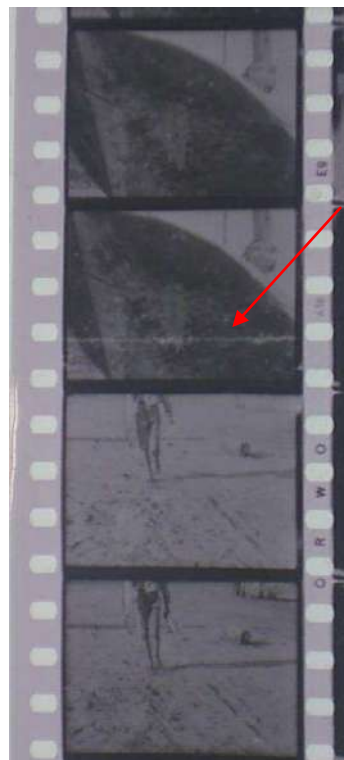
Imagem 20 - Marca de emenda com contornos claros em corte entre planos iniciais do Rolo 3.
