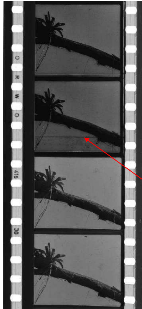
Imagem 44 - Marca de emenda com contornos escuros na Cópia Máster MAM.
