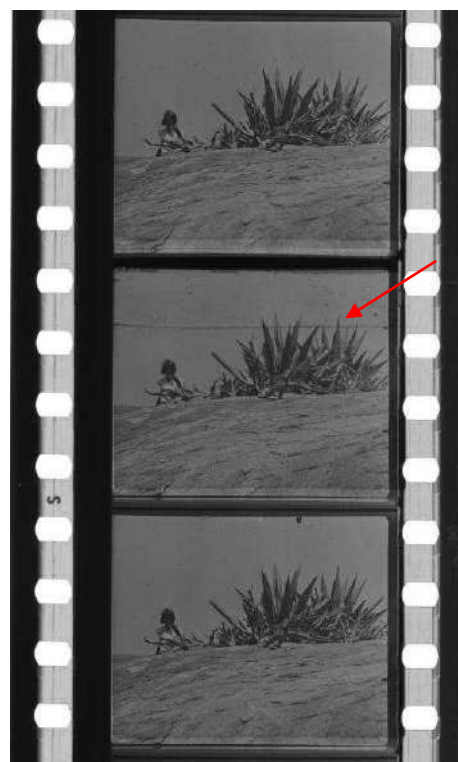
Imagem 35 - Marca de emenda com contornos escuros no Plano 141.
