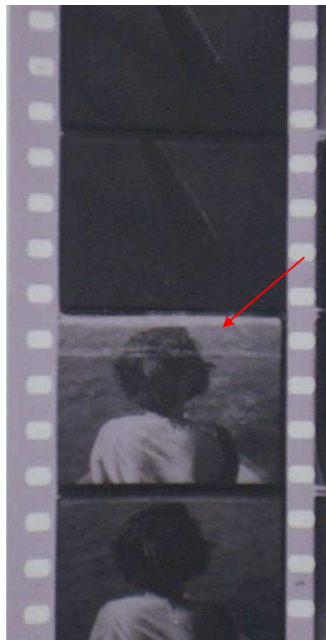
Imagem 18 - Marca de emenda impressa no Rolo 1 do Máster CB.
